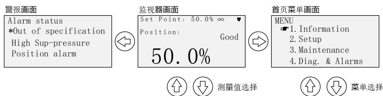
图 4.1.3a 液晶显示屏画面的切换
